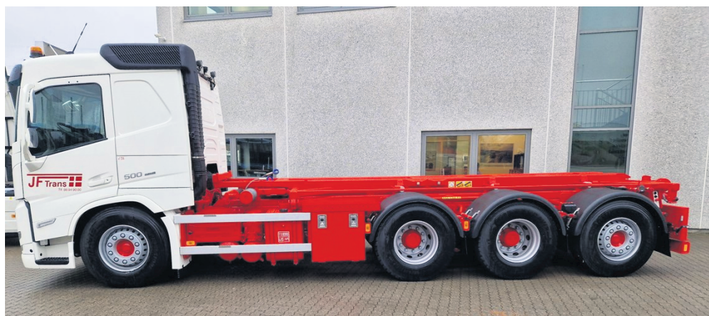
En trippelbil med tre bagaksler må maksimalt have 24 ton på de tre bagaksler til sammen - også efter at de nye regler er trådt i kraft. Foto: Sawo
