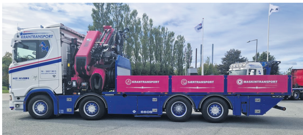
En 2+2-bil kan komme op på de 36 ton ved for eksempel at have 19 ton på de to bagaksler og to 9-ton foraksler. Foto: Sawo
